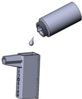
Versez la solution Native dans le réservoir par l'orifice prévu à cet effet. Attention : remplir jusqu'à la limite des renforts internes du réservoir (voir ci-dessous).
