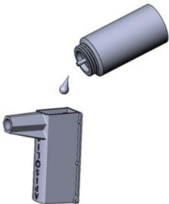
Vierta la solución Native en el depósito a través del orificio previsto. Ojo: llenar hasta el límite de los refuerzos internos del tanque (ver más abajo).
