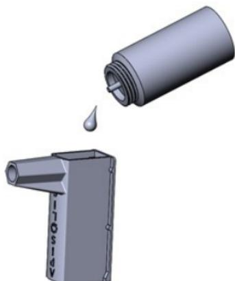
Giessen Sie die Native-Lösung durch die vorgesehene Öffnung in den Tank. Achtung: nur bis zur Höhe der im Tank befindlichen Rippen auffüllen (siehe unten).
